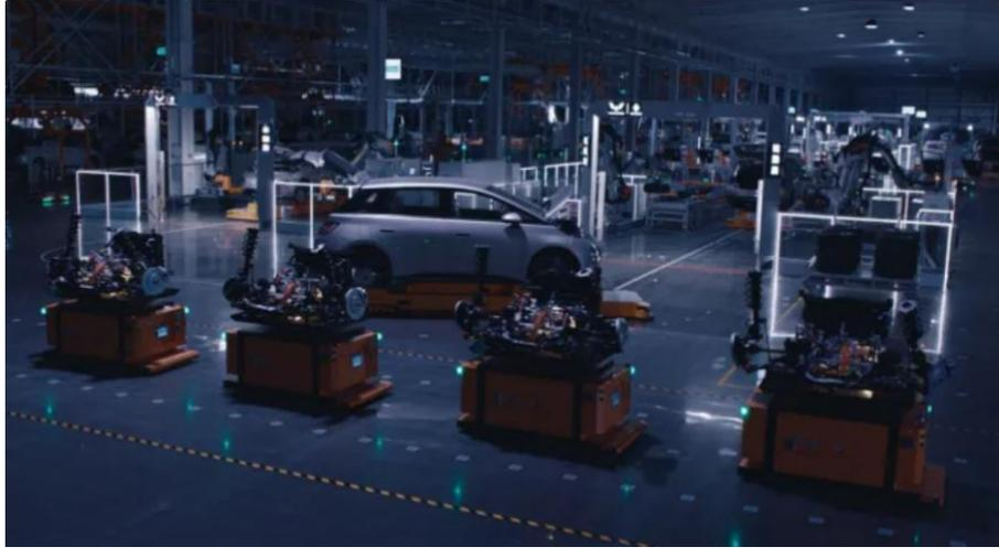
**技术优势：**支持 SLAM 技术 (Simultaneous Localization and Mapping, 即时定位与地图构建) 的复合式导航移动机器人和 EMS 可升降吊具 (Electrified Monorail System, 电动单轨输送系统) 的应用, 以及 AGV (Automated Guided Vehicle, 自动导向车) 等运输单元的智能调度, 让工厂能够灵活传送车身、配件等各类生产对象, 实现“车找工位”“料找车”的无缝衔接。岛与岛之间没有采用传统的串联方式, 而是运用了柔性可变的分布式结构, 因而可以不受传统流水线工艺要求限制, 实时依据生产需要变换工序。
