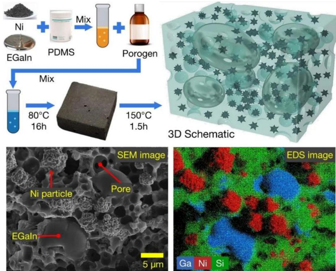
技术优势：通过优化材料组分和制备方法，该复合材料在宽压力范围内表现出了显著提高的灵敏度。这种优化的多孔复合材料在 1 MPa 压力下表现出了七个数量级的电导率增长，并在高达 8.9 MPa 的大压力范围内保持了高度线性的响应，线性度  $R^2$  高达 0.9992。
