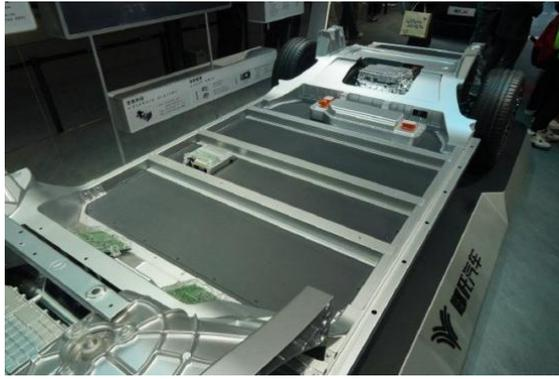
技术优势：浩智滑板底盘的设计相对于大众 MEB、现代 E-GMP、丰田 e-TNGA 电动车底盘，采用铝挤压成型工艺制造底盘横纵梁，这种挤压成型工艺能够提供较高的成形压力和变形速率，使得铝材料在加工过程中得到较细小的晶粒结构，从而提高了材料的强度和刚度。同时采用一体化压铸，减少零部件 100 多个，减少焊点 1700 多个。铝制材料的采用和零部件的减少使下车身减重 16%，焊接点的减少，同时减少焊接点处扭转刚度的影响，使整车扭转刚度提升 30%，一体式的结构可以避免传统结构连接处的松动和变形，进而使底盘安装点动刚度提升 40%。
