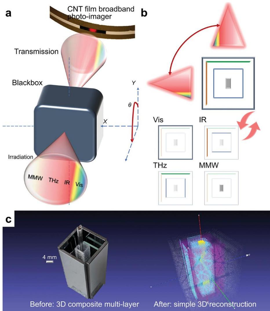
这项研究工作的概念图。a 和 b：超宽带视觉壳体重建；b：三维多层物体的特定波长提取的示意流程；c：超宽带视觉壳体重建前后三维多层物体的简单比较。
