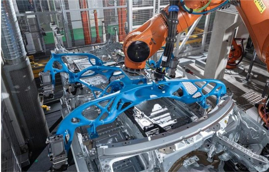
技术优势：利用增材制造技术打印夹持器的时间为 22 小时，具有很高的效率。这款机器人夹持器重约 120 公斤，通过利用这一工艺，最终产品重量减轻了 20%。通过利用回收的塑料颗粒作为原材料，使得生产过程的中二氧化碳排放量显著减少了 60%。同时，由于轻量化的设计，机器人的重量减轻，使得生产所需的机器人数量减少，从三个减少到一个。
