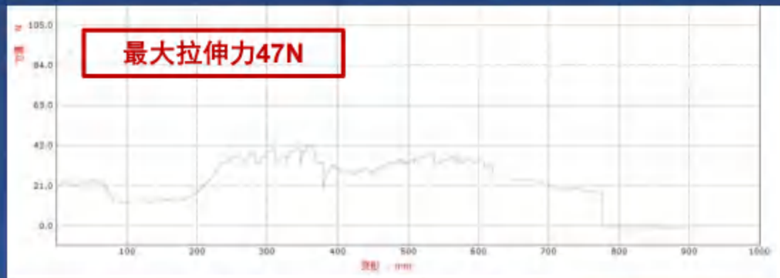
漆面样片经过等离子处理后的测试数据
